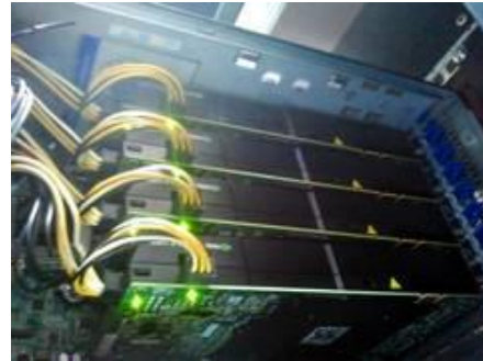
Abb. 1: NVIDIA Tesla K40 GPU (links). Multi-GPU Server mit 4 NVIDIA Tesla C2075 GPUs (rechts).
